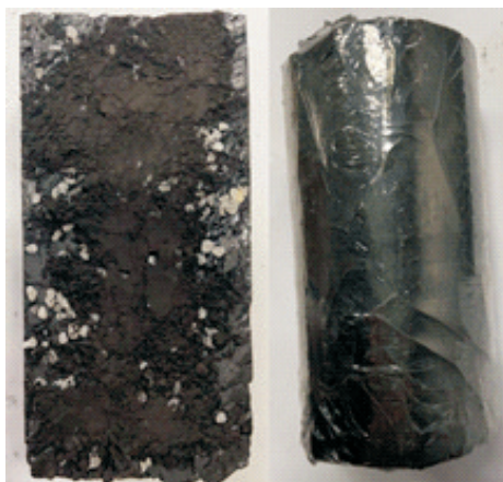
图2 支撑剂煤粉充填裂缝的原生结构煤岩样品
